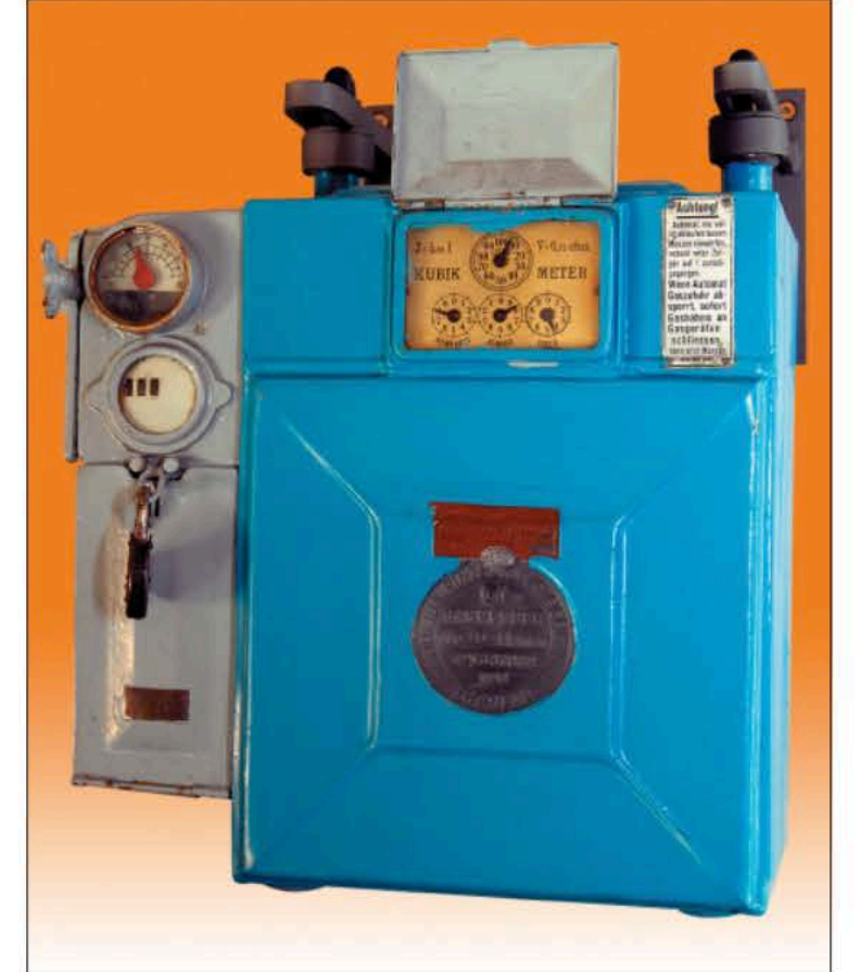
Gazomierz na żetony „Pintsch” 1920 r. – Muzeum Gazownictwa w Paczkowie / A “Pintsch” token gas meter from 1920 (fot. M. Kucharczyk)
