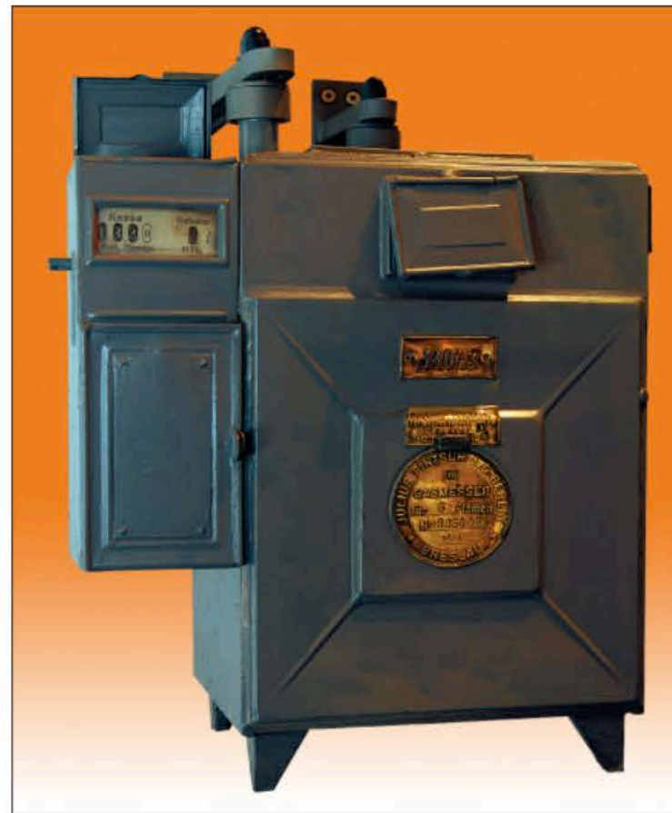
Gazomierz na żetony „J. Pintsch” 1914 r. – Muzeum Gazownictwa w Paczkowie / A “J. Pintsch” token gas meter from 1914 (fot. M. Kucharczyk)
