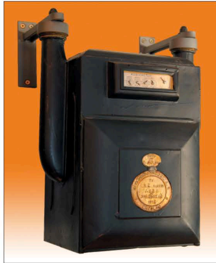
Gazomierz miechowy „KROMSCHRÖD ER” 1918 r. – Muzeum Gazownictwa w Paczkowie / Gas Industry Museum in Paczków: a “KROMSCHRÖDER” bellows gas meter, 1918 (fot. M. Kucharczyk)
