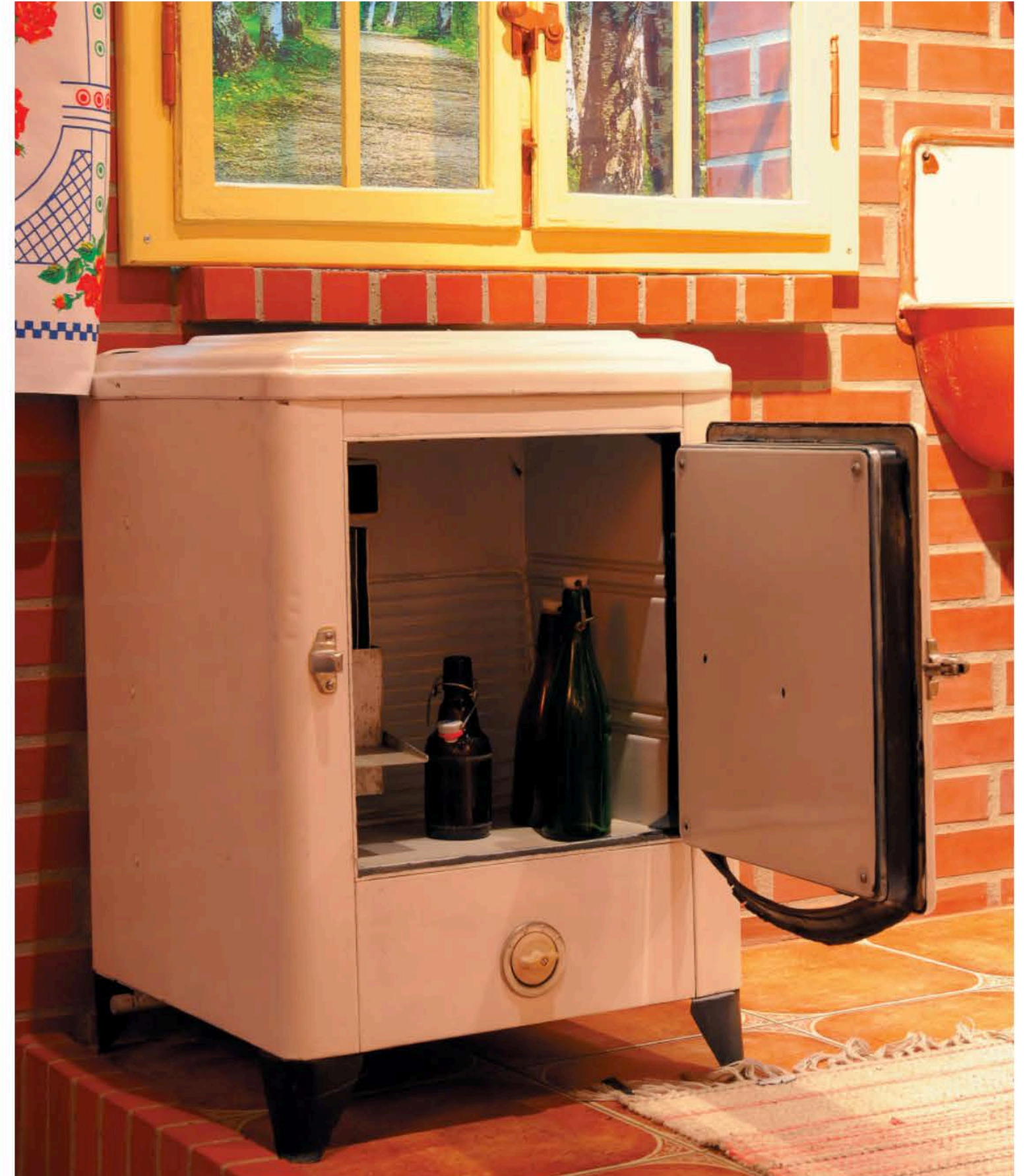
Łodówka gazowa do działania wykorzystuje zasadę absorpcji. Amoniak wytrącany jest z wodnego roztworu w podgrzewanym palnikiem gazowym wężu, skąd przedostaje się do chłodzonego powietrzem skraplacza; następnie – już jako ciecz – do parownika we wnętrzu komory chłodniczej, gdzie, parując, odbiera ciepło od otoczenia. Opary amoniaku są następnie absorbowane przez wodę w pochłaniaczu. Roztwór wraca do wężu. – Muzeum Gazownictwa w Paczkowie / Gas Industry Museum in Paczków: A gas fridge based on the law of absorption. Ammonia is extracted from water solution heated up in a boiling pot from which it enters an air-cooled condenser. Then, as a liquid, it enters an evaporator, where it receives ambient heat. Ammonia mist is then absorbed by water in the absorber. The solution is recycled into the boiling pot (fot. M. Kucharczyk)
