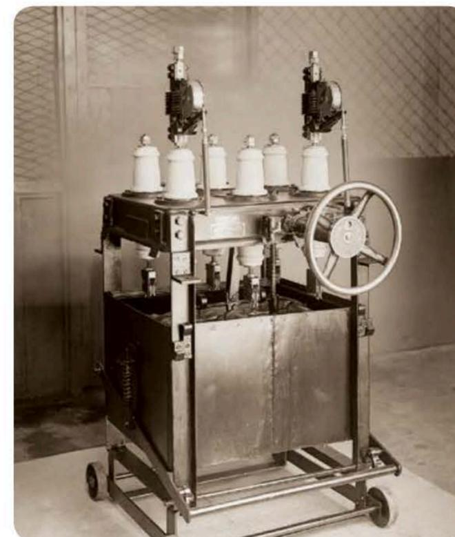
Wyłącznik olejowy R10 z przekaźnikami BBC / R10 oil switch with BBC transmitters (arch. Photofactory®)
