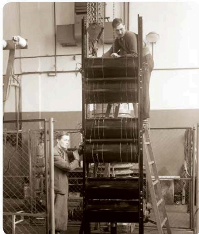
Kaskadowy transformator probierczy 450 kV / 450 kV cascade test transformer
