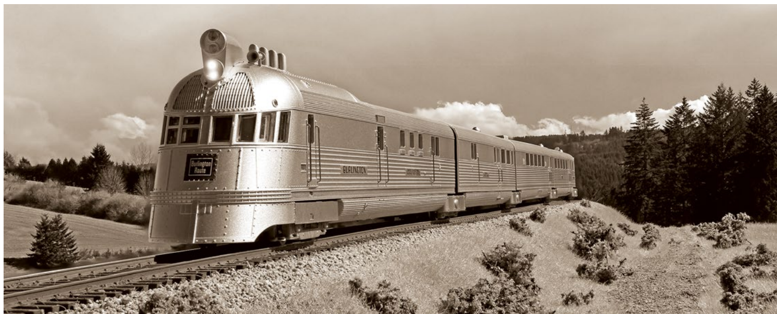
Pierwszy spalinowo-elektryczny pociąg „Burlington Zephyr” uruchomiony został w 1934 r. na linii Denver-Chicago. Każdy „Zephyr” składał się z trzech wagonów i charakteryzował się lekką konstrukcją z duraluminium oraz opływowym kształtem. Łącznie powstały 72 takie pociągi / The first diesel-electric train, “Burlington Zephyr” was put into service in 1934 on the line from Denver to Chicago. Each “Zephyr” was made of three cars and had light alloy duralumin structure and streamlined shape. In total 72 such trains were built (©Photofactory®)
