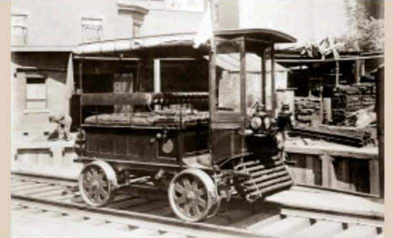
Omnibus szynowy napędzany gazoliną, Nowy Jork – II poł. XIX w. / A gasoline-driven rail omnibus, New York – second half of the 19<sup>th</sup> century
