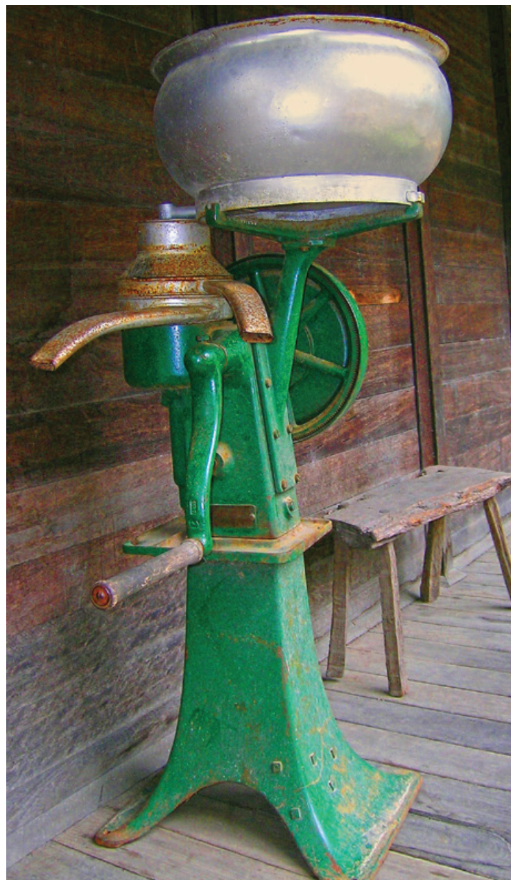
Wirówka separująca tłuszcz z mleka pełnego
