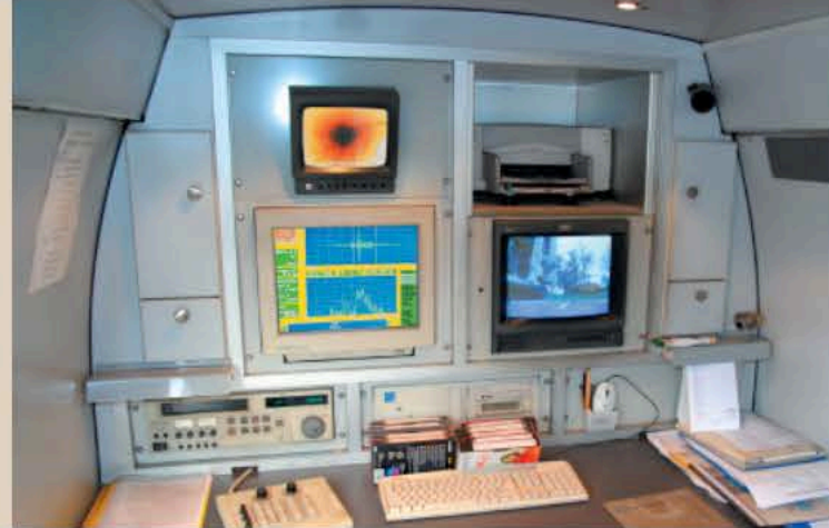
Wnętrze samochodu do teleinspekcji kanałów
