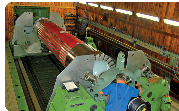
Wirnik w odwirowni / Rotor in the rotor plant
